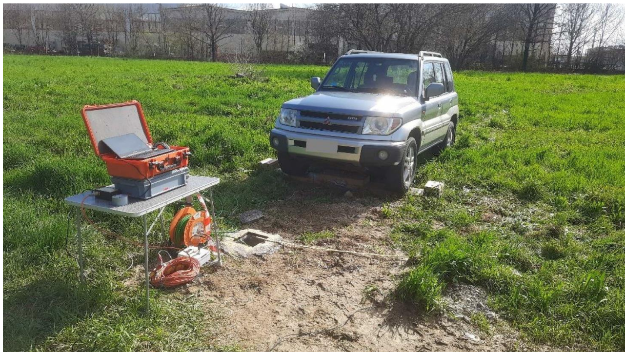
FIG. 3 – REALIZZAZIONE DELLA PROVA SISMICA DOWN-HOLE IN COMUNE DI MONTECCHIO EMILIA
